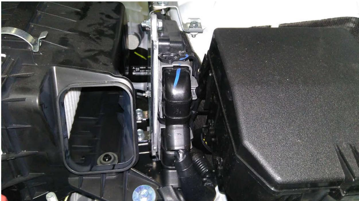
3. Установить защиту на блок управления двигателем.
